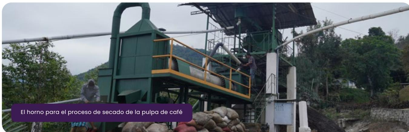
El horno para el proceso de secado de la pulpa de café
